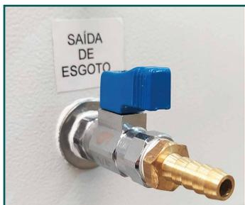
Das duas válvulas localizadas na parte inferior do equipamento, a de baixo refere-se a saída de água do produto.
