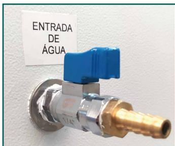
Das duas válvulas localizadas na parte inferior do equipamento, a de cima refere-se a entrada de água do produto.
